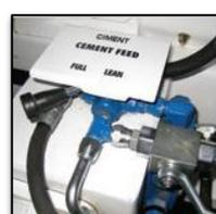
**Medidor variable de cemento**
