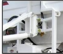
**Actuador de giro hidráulico, oscilación de potencia**
