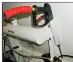
Sistema de lavado de Presión
