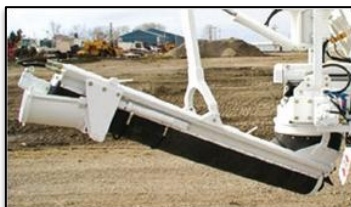
Gusano Mezclador, diámetro mayor de 320mm
